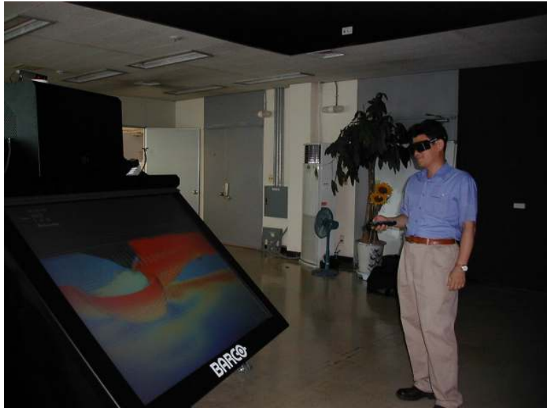
[ 반몰입형 입체 VR Table의 운영모습 ] 대각선 1.8m의 영상테이블에 3차원 해양모델의 결과를 입체로 렌더링 하여 수중구조를 분석할 수 있다.
