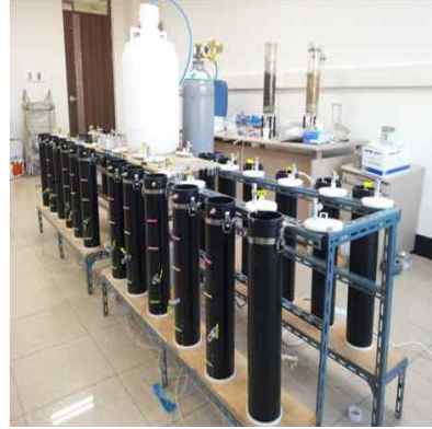
그림 1. 컬럼 실험장치 개념도(왼쪽)와 실제 사진(오른쪽)
