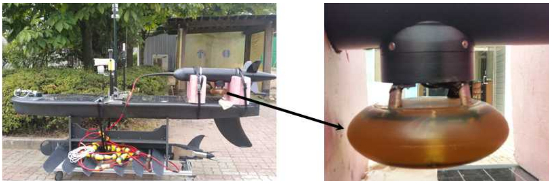
그림 1-3. KIOST 도입한 Wave glider와 방향성 수중청음기.
