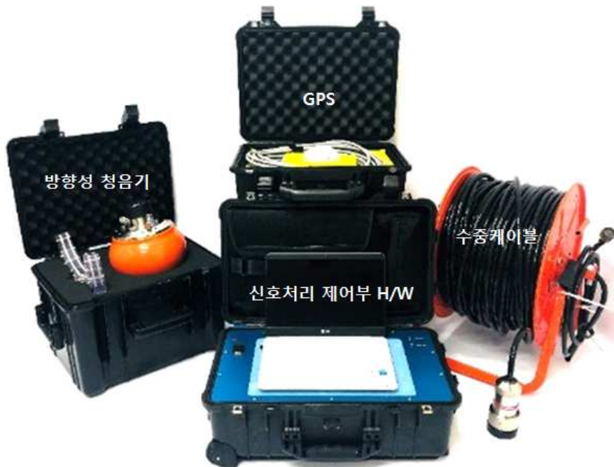
그림 3-68. 방향성 청음기 최종 시제품 구성.
