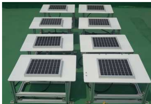
그림 217. 적조 음향탐지 시스템 설치대
