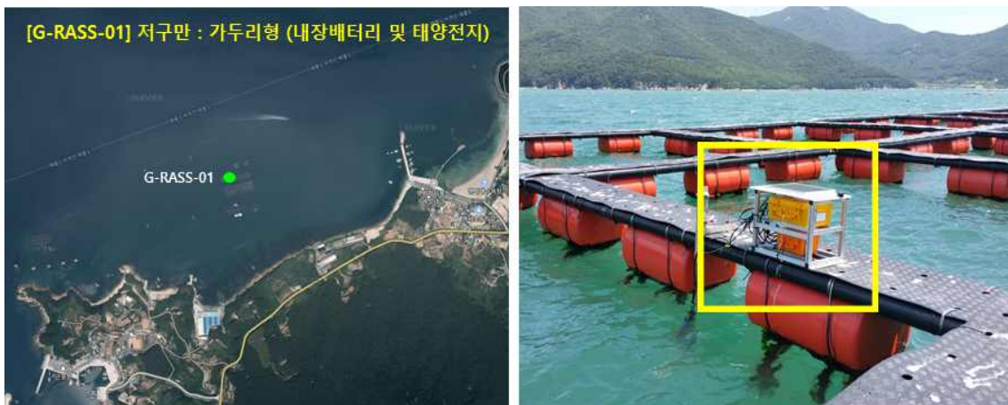
그림 94. 거제 저구만 민간 양식장에서 운용한 적조 음향탐지 시스템 (G-RASS-01)
