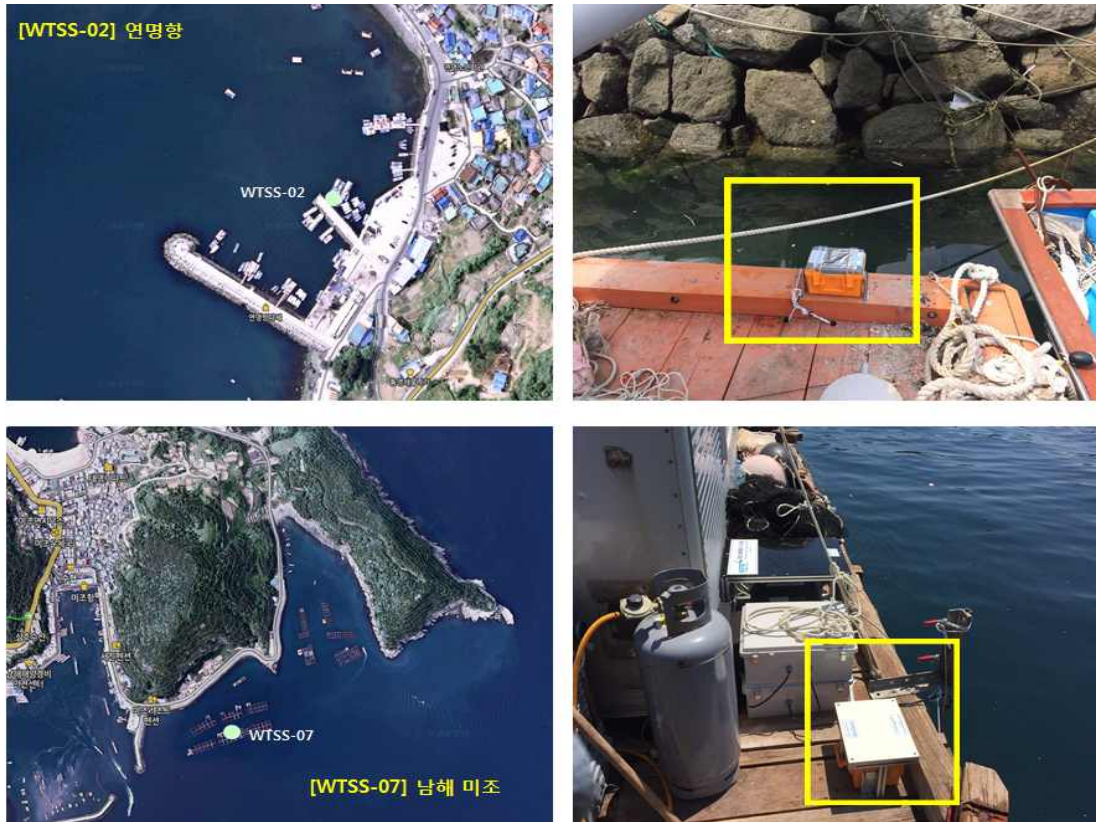
그림 102. 1차년도 연명포구, 남해 미조에서 운용한 고수온 관측 시스템
