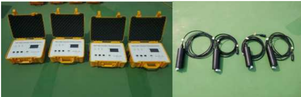
그림 16. 적조 음향탐지 시스템 및 센서, 음향 강도 측정 장비
