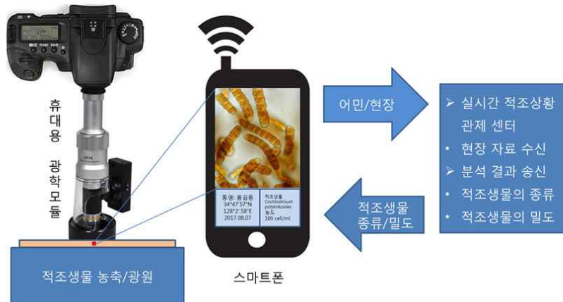
그림 209. 휴대용 적조 광학 탐지 장치 개념도
