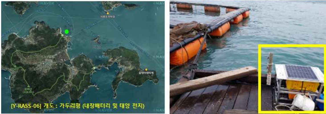
그림 88. 여수 개도 민간 양식장에서 운용한 적조 음향탐지 시스템 (Y-RASS-04)
