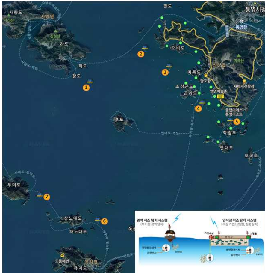
그림 8. 통영 연안 양식장 적조의 실시간 탐지를 위한 시스템 설치 안
