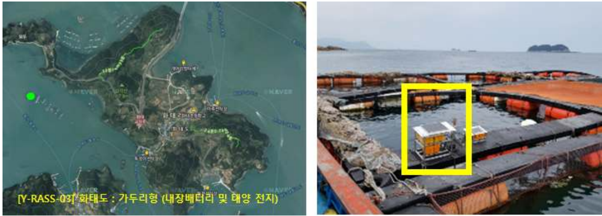
그림 85. 여수 화태도 민간 양식장에서 운용한 적조 음향탐지 시스템 (Y-RASS-03)
