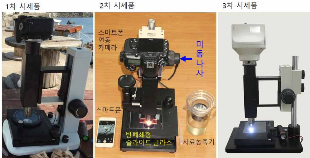
그림 212. 휴대용 적조 광학 탐지 모듈 1차 모델(좌), 2차 모델(중), 3차 모델(우)
