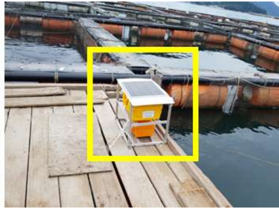
그림 91. 여수 대두라도 민간 양식장에서 운용한 적조 음향탐지 시스템 (Y-RASS-05)
