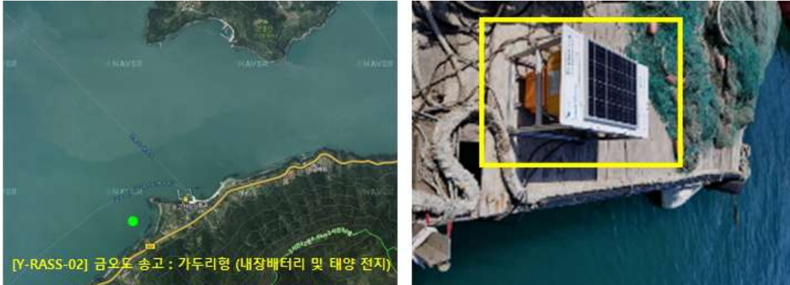
그림 82. 여수 금오도 송고 민간 양식장에서 운용한 적조 음향탐지 시스템 (Y-RASS-02)
