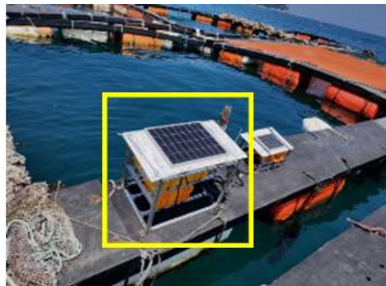
그림 79. 여수 금오도 장지 민간 양식장에서 운용한 적조 음향탐지 시스템 (Y-RASS-01)
