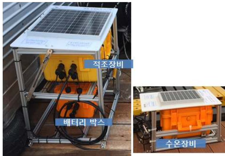
그림 216. 적조 음향탐지 시스템 및 고수온 관측 시스템 현장 설치 구성
