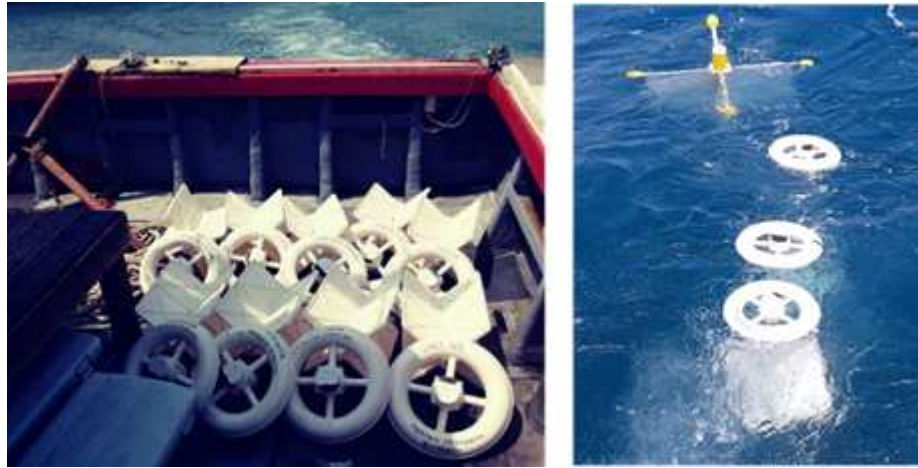
그림 1. 선박에 적재된 CARTHE 드리프터(좌). CARTHE와 함께 투하된 K-1 드리프터(우). CARTHE와 K-1드리프터 간의 거동 차이는 나타나지 않았음.
