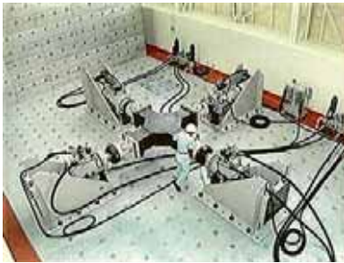
복합하중시험장치 (가반식재하(載荷)장치)
