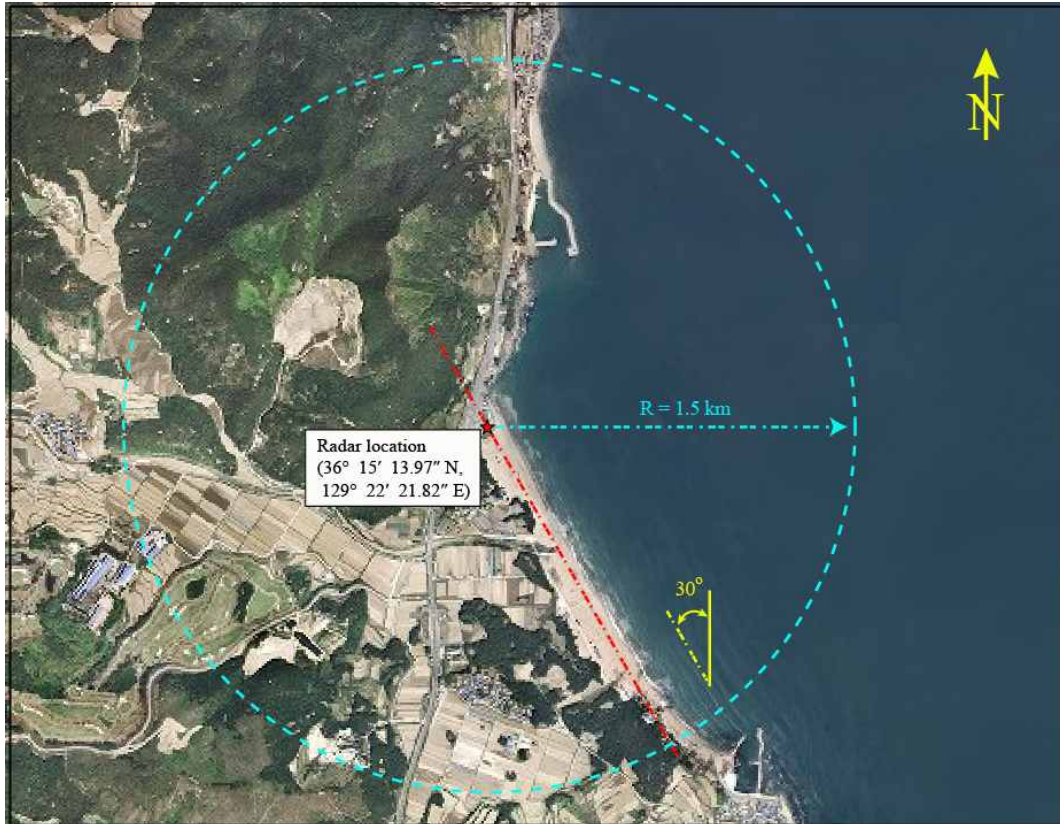
그림 2.17 2004년 12월, 경북 포항시 인근 동해 연안에서 실시한 레이더 파랑관측 실험의 장소 및 레이더의 측정 범위 (위성영상 사진 출처: map.naver.com).
