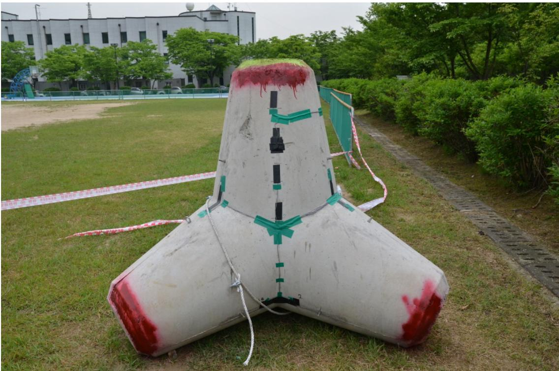
그림 3.2.30 구형 소파블록 계측센서 설치전경 : 하부 시준
