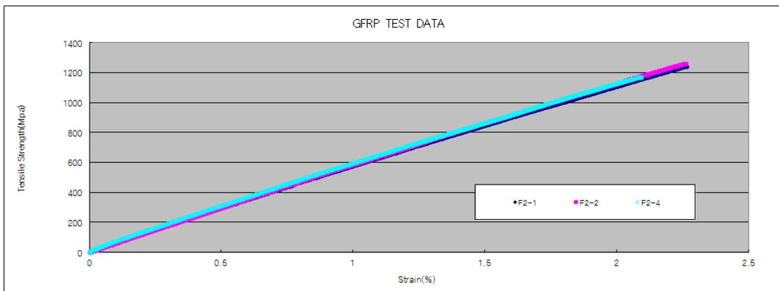
그림 3.2.62 FRP 봉의 응력-변형률선도
