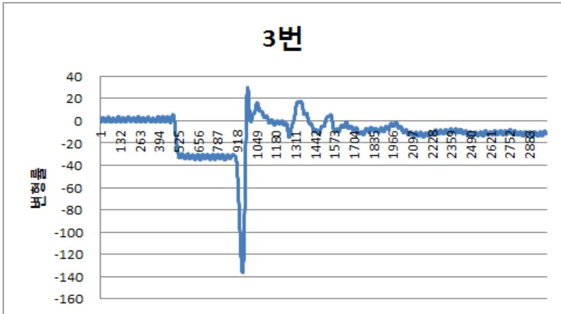
그림 3.2.38 10cm 자유낙하실험부재의 분기부 응력 : 인장응력
