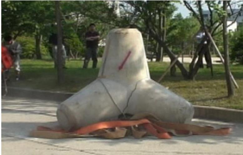
그림 3.2.49 콘크리트바닥 3점낙하 발생 균열 (실험)
