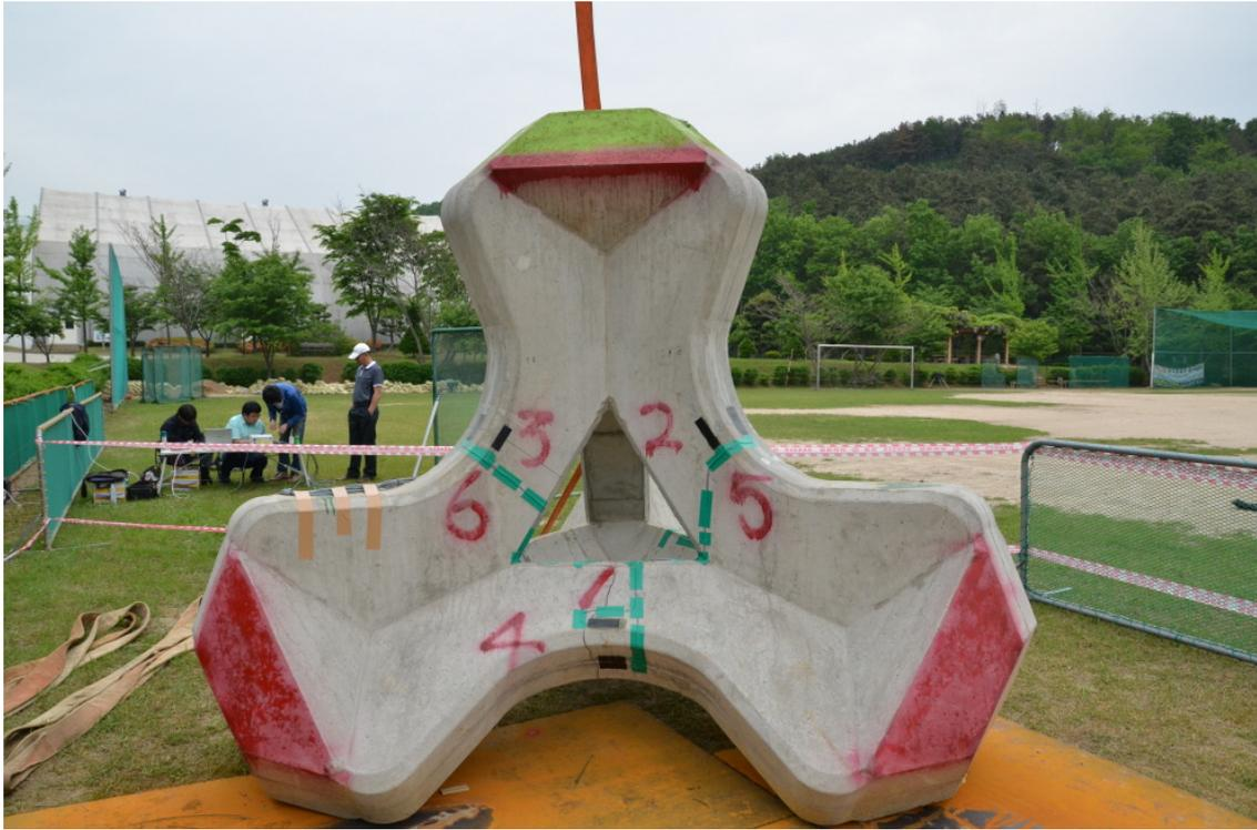
그림 3.2.29 신형 소파블록 계측센서 설치전경 : 하부 시준
