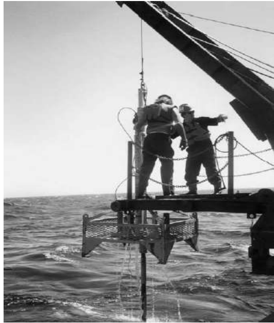
<그림 3-18> A Halibut vane test rig during recovery
