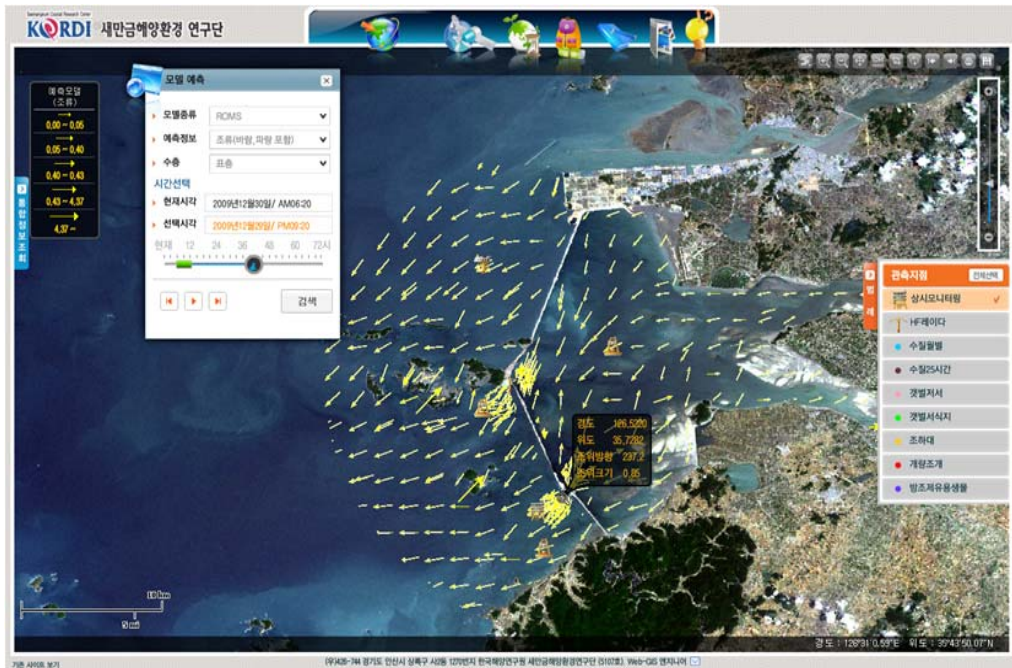
그림 6 HF Radar를 통해 관측되는 표층해류의 웹GIS 서비스 예
