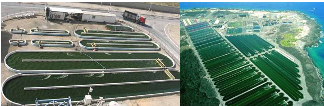
<그림 2-1> 미세조류 대량 배양용 Raceway pond형 배양 시설
