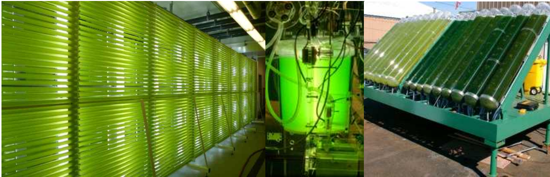
<그림 2-2> 미세조류 배양용 Photobioreactor형 배양 시설
