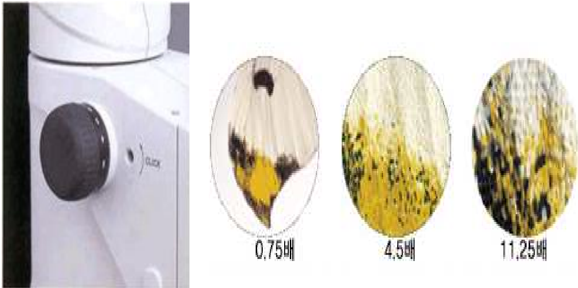
[그림 5-4] 대물렌즈 배율조절기 및 주요 배율별 이미지 예시
