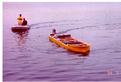
수상선의 조종 성능 해석을 위한 실험 장면(좌:HPMM시험, 우:자유항주실험)
