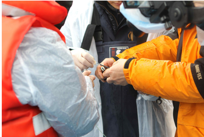
그림 3-1-12. PSAT와 플라스틱 패드 연결 수 나일론 와이어의 매듭 부분을 수축 튜브를 이용해 감싸고 있는 장면
