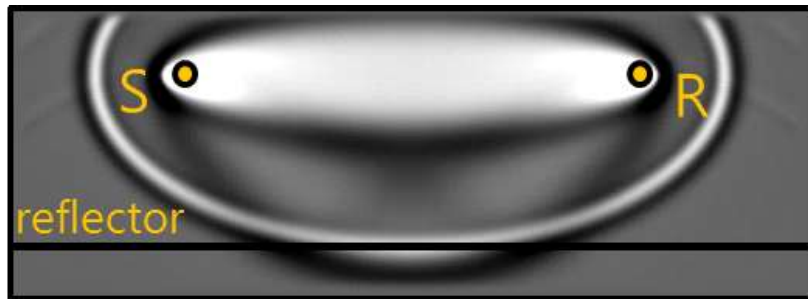
그림 3-8. 오프셋 길이와 역산 가능 파수의 깊이를 보여주는 민감도 분석 결과
