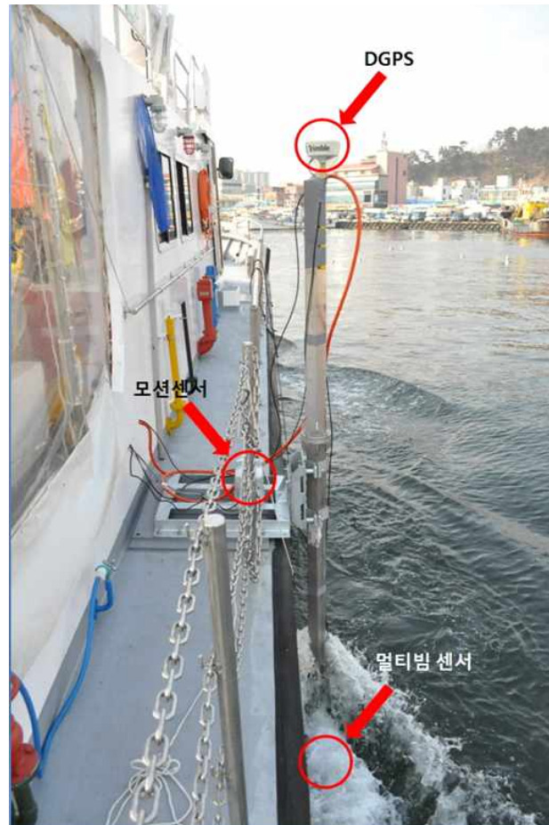
그림 3-4-6. 멀티빔에코사운더와 동일 수직선 상에 위치하도록 각각의 센서들을 설치
