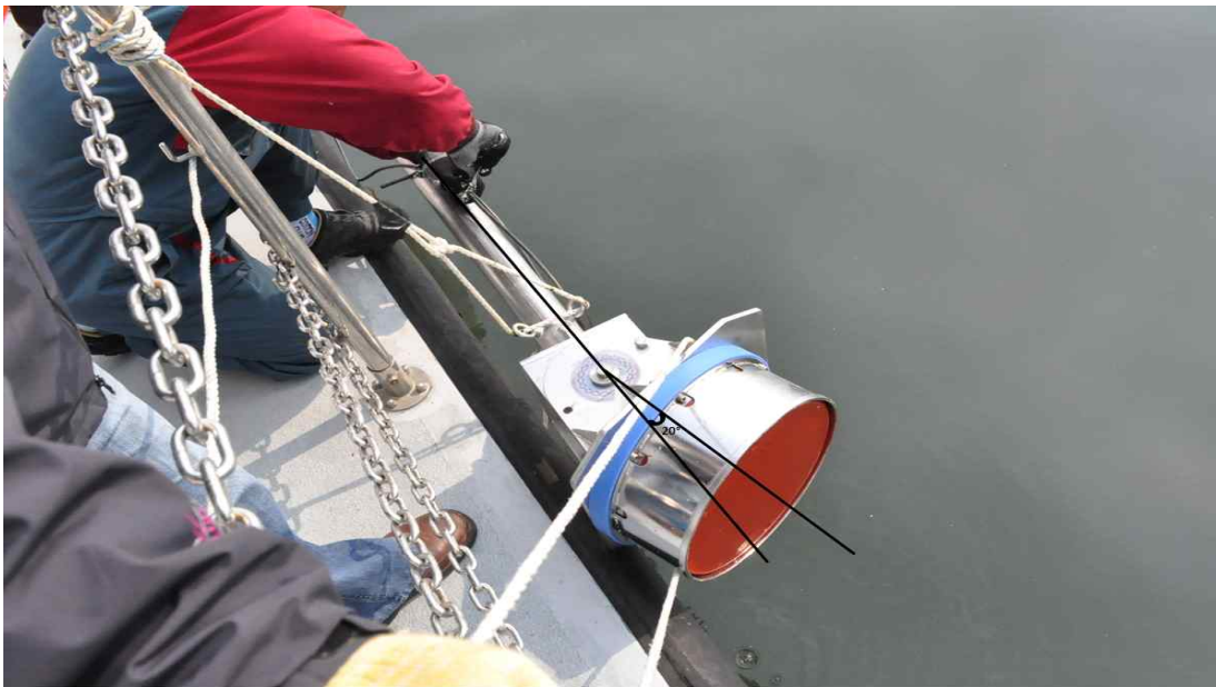
그림 3-4-8. Transducer를 선박의 외곽 방향으로 30° 회전시켜 설치
