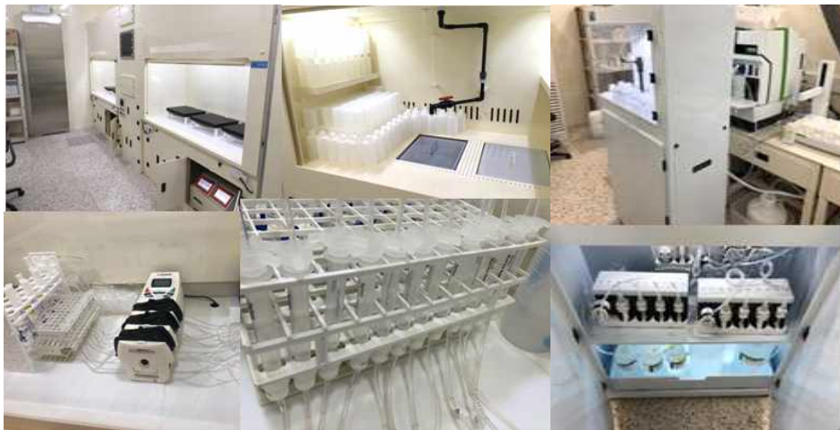
그림3-2-4 연구청사 1연구동에 구축된 청정 실험 환경과 용존 미량원소 전처리 장비 (왼쪽)과 본 청정실험실에 구축된 해수 중 용존 미량원소 전처리-질량분석기 (seaFAST)의 운용 사진 (오른쪽)
