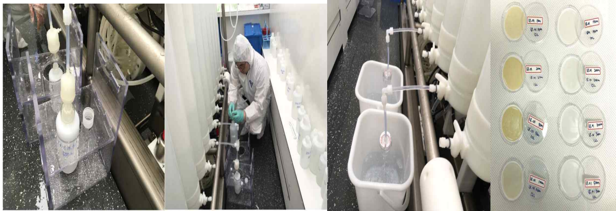
그림3-2-2 UCC를 이용한 용존 (물시료) 청정 해수 시료 여과 및 시료 채취 모습 (왼쪽) UCC 채수기 이용한 입자태 미량금속 시료 여과 및 시료 채취 모습 (오른쪽)
