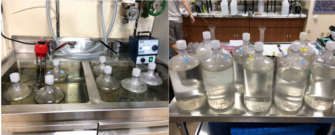
그림3-1-3 Mn 공침전물을 만들기 위해 전처리 중인 시료를 heating시키는 모습(왼쪽)과 침전물 생성 후 여과 직전 침강 시키는 모습(오른쪽)
