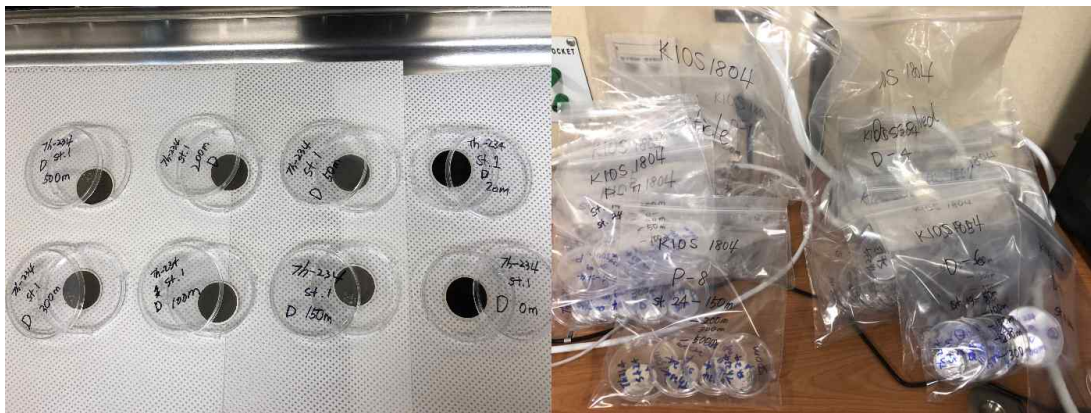
그림3-1-4 Mn 공침 시료를 여과(왼쪽)하고 이를 계측 전 plating 한 모습(오른쪽)
