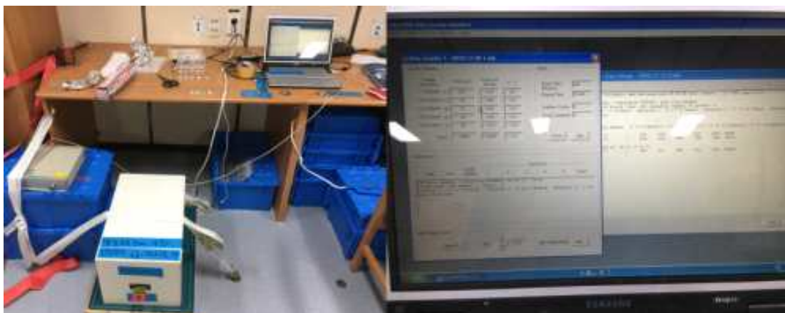
그림3-1-5 선상에 비치한 방사능 계측기인 베타( \beta )-카운터와 실제 계측 화면
