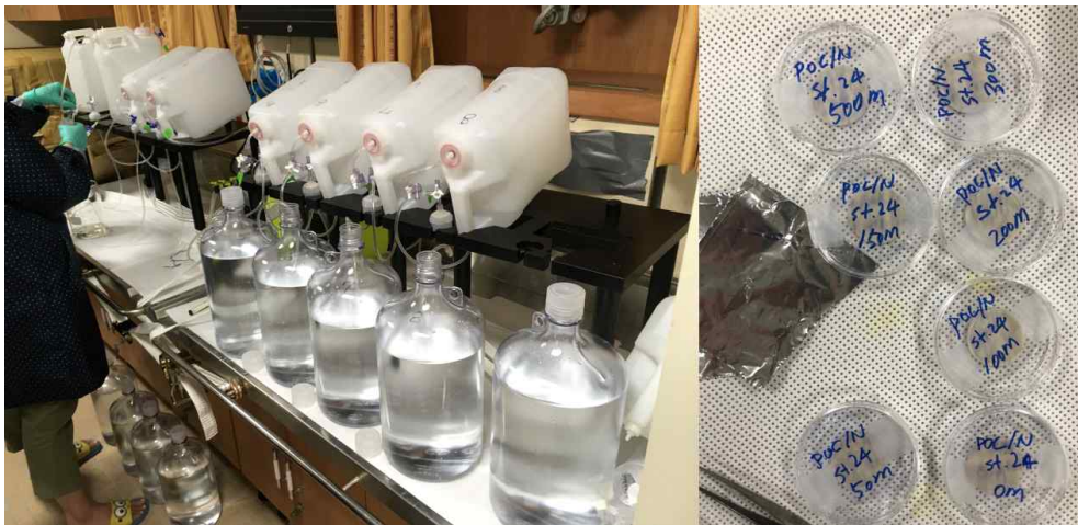
그림3-1-1 본 연구진이 개발한 다채널 해수 시료 여과장치 및 여과된 입자상 시료
