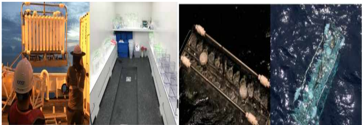
그림3-2-1 UCC deployment작업과 청정 실험실 컨테이너 내부 (왼쪽), UCC를 해수면에 deploy 한 후, 수심 50 m에서 채수기가 자동 개방된 모습 (오른쪽).
