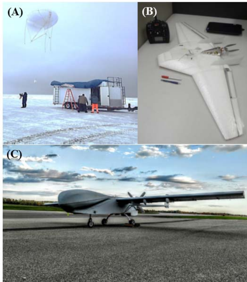
그림 2-7. 미국 ARM 그룹에서 운영하는 대기관측 시스템 (A) Tethered Balloon (B) DataHawk Small Fixed-Wing UAV (C) Group 3 UAV
