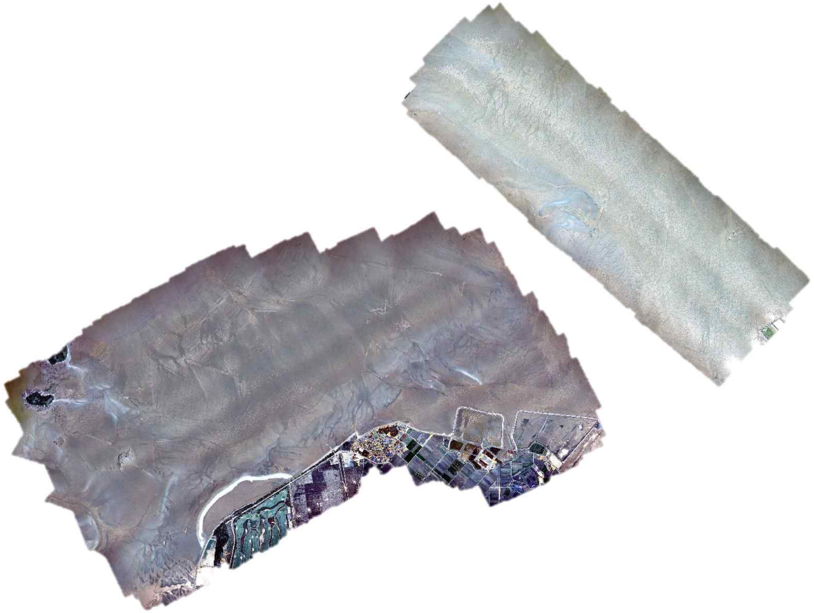
그림 3-1-1-11. 고정익 무인항공기를 활용하여 획득한 연구지역의 정사영상
