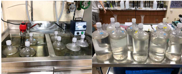
Fig. 3.4.2.9. Mn 공침전물을 만들기 위해 전처리 중인 시료를 가열하는 모습(왼쪽)과 침전물 생성 후 여과 직전 침강시키는 모습(오른쪽)
