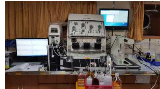
Fig. 3.2.1.1. 이사부호 화학실험실에 설치된 SEAL사 QuAAtro 영양염 자동분석기
