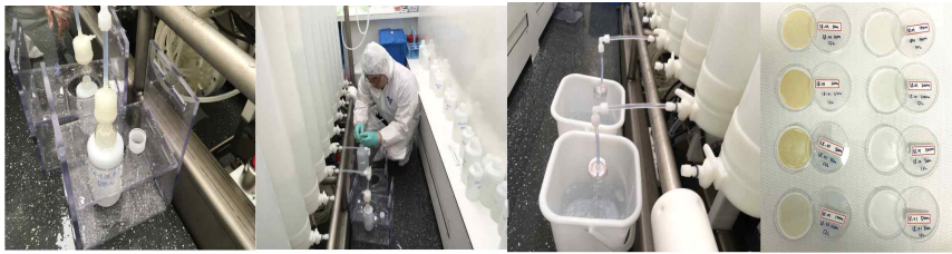
Fig. 3.4.2.2. UCC를 이용한 용존(물시료) 청정 해수 시료 여과 및 시료 채취 모습(왼쪽) UCC 채취기 이용한 입자태 미량금속 시료 여과 및 시료 채취 모습(오른쪽)
