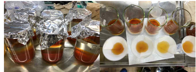
Fig. 3.4.2.18. 각 시료의 철 침전물(상등액 제거 후) 생성 모습(왼쪽)과 여과 모습(오른쪽)
