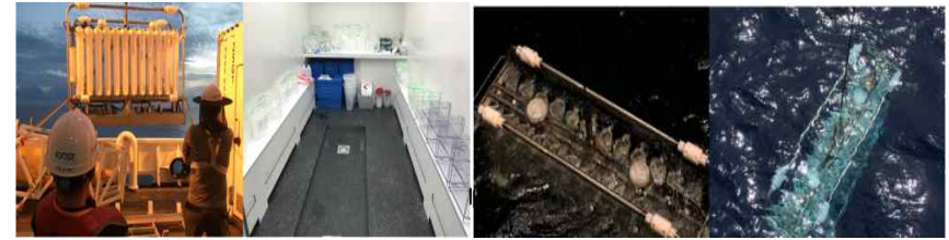
Fig. 3.4.2.1. UCC deployment작업과 청정 실험실 컨테이너 내부 (왼쪽), UCC를 해수면에 deploy 한 후, 수심 50 m에서 채수기가 자동 개방된 모습 (오른쪽)
