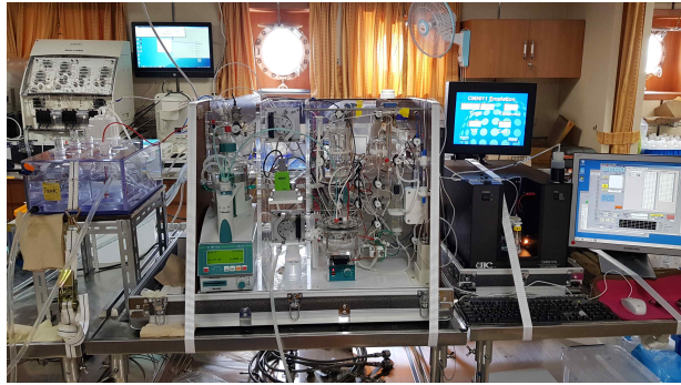
Fig. 3.3.2.1. 이사부호 화학실험실에 설치된 무기탄소 및 총알칼리도 측정을 위한 VINDTA 3C 및 전기량계
