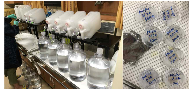
Fig. 3.4.2.7. 본 연구진이 개발한 다채널 해수 시료 여과장치 및 여과된 입자상 POC시료
