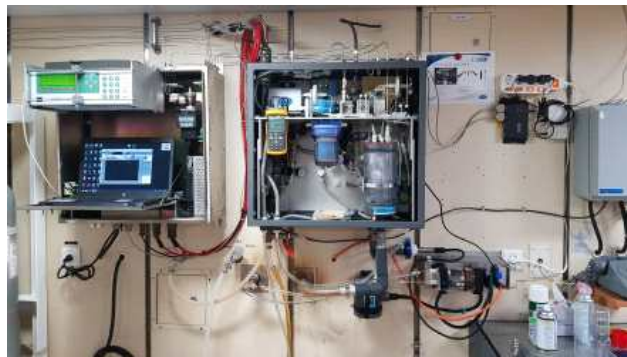
Fig. 3.3.1.4. 이사부호 화학실험실에 설치된 표층해수 및 대기 중 pCO 2 연속관측시스템
