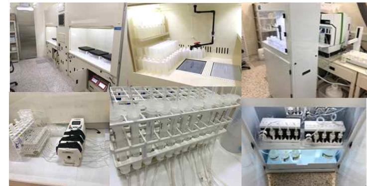
Fig. 3.4.2.4. 연구청사 1연구동에 구축된 청정 실험 환경과 용존 미량원소 전처리 장비(왼쪽)와 본 청정실험실에 구축된 해수 중 용존 미량원소 전처리-질량분석기(seaFAST)의 운용 사진(오른쪽)
