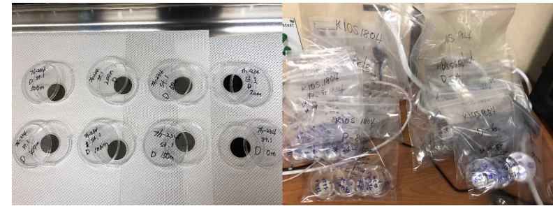
Fig. 3.4.2.10. Mn 공침 시료를 여과(왼쪽)하고 이를 계측 전 plating한 모습(오른쪽)
