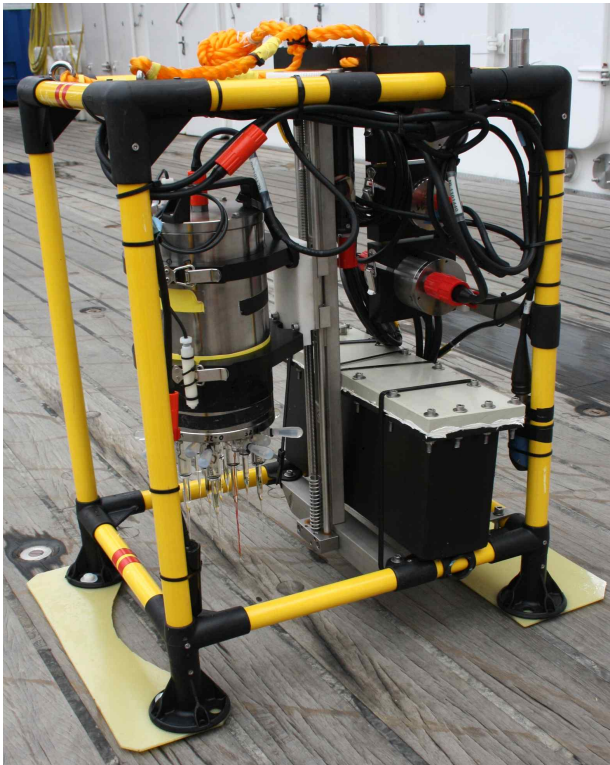
그림 6 마이크로프로파일러 모듈 (좌), pH, 황화수소, 온도, 용존산소 마이크로센서가 장착된 프로파일러(우)
