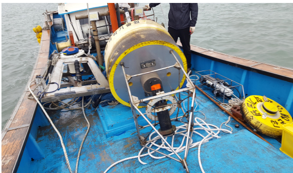
그림 23. 온배수 배수구 인근에 계류된 해양부이의 모습. 부이 하단에 해류계 장착됨.
