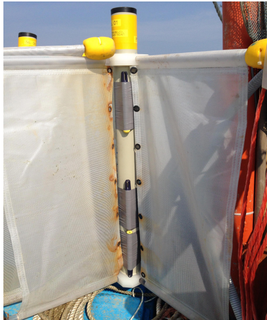
그림 24. 수온계를 장착한 표층뜯개의 측면도. 수온센서는 수면하 0.05m, 0.5m, 1m에 각각 장착됨.
