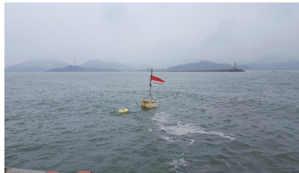
그림 23. 온배수 배수구 인근에 계류된 해양부이의 모습. 부이 하단에 해류계 장착됨.
