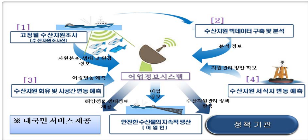
〈그림 1-1-27〉 수산자원조사 정보 통합관리시스템 개념도
