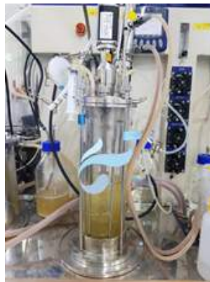
그림 3-79. 하동발전 개미산이용 KIOST 회분배양 반응기 사진
