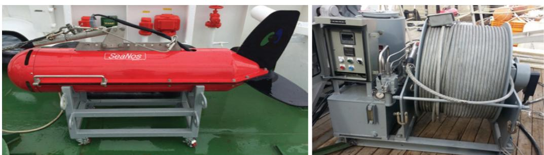
그림 3.4.4. 수중음원 발생 시스템 Towing body 및 유압 원치
