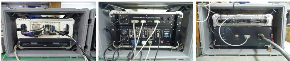
그림 3.4.3. 수중음원 발생 시스템 신호 제어부 및 파워앰프
