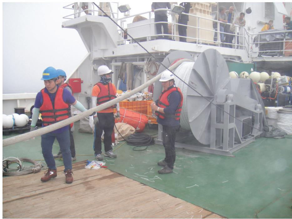
그림 3.4.8. 음향 선배열 센서 및 유압 원치 현장 운용 예
