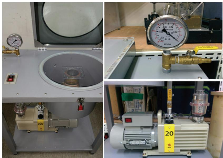
그림 3.1.4. 진공챔버 (Vacuum chamber)
