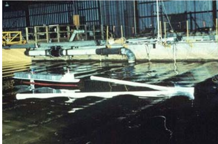
그림 3.3.26 평면수조에서의 RIB 실험 모습
