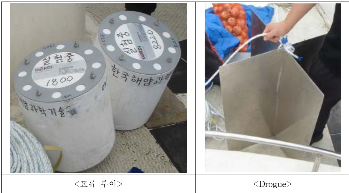
그림 3.1.71 실험에 사용된 부이(좌) 및 드로그(우)
