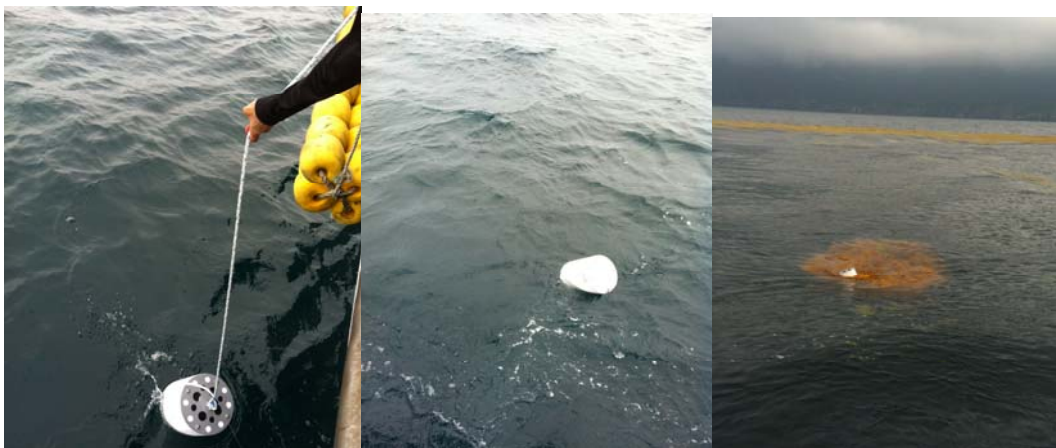
그림 3.1.72 표류부이 투하 시 및 투하 후 표류 모습
