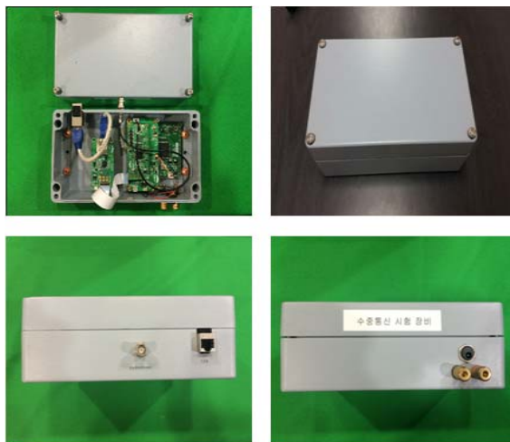
그림 3.3.3 부착형 수중청음기(상), 수중통신모뎀장치(하) 실물 사진 및 장치 사양
