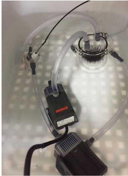
그림 2-2-20. 산소 소비율 측정 장비 설치 모습
