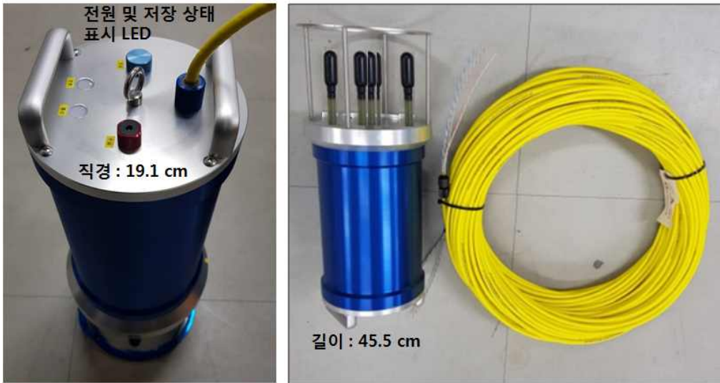
그림 17. 방향성 탐지 prototype 하이드로폰 시제품 형상.
