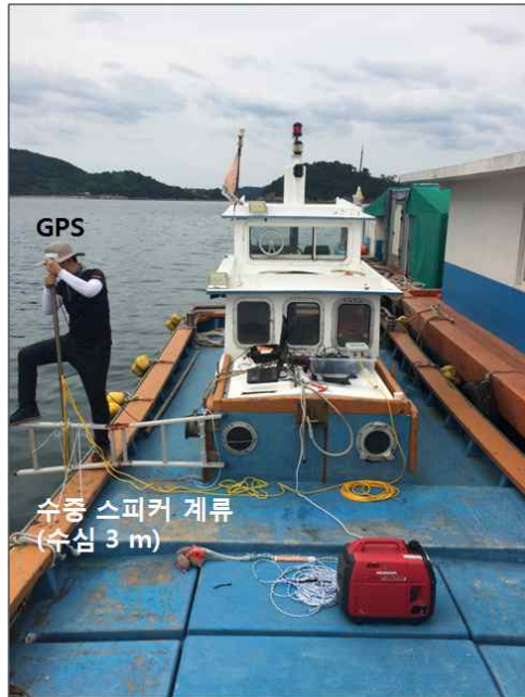
그림 27. 선박 기동음원 음향 시험 조사선 및 수중스피커 계류 모습.
