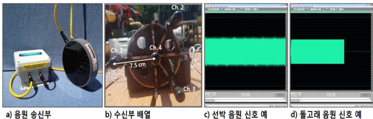
그림 24. 해상 시험 음원 송신부, 수신부 및 음원 신호 예.
