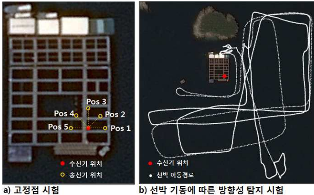
그림 25. 해상에서 고정점 및 선박 기동에 따른 방향성 탐지 시험 모식도.
