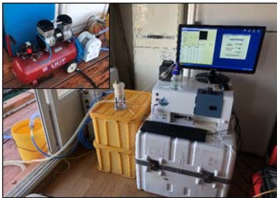
통영양식장 설치 환경 (실내): FlowCAM, Injector / (실외): 펌프 및 압축기
