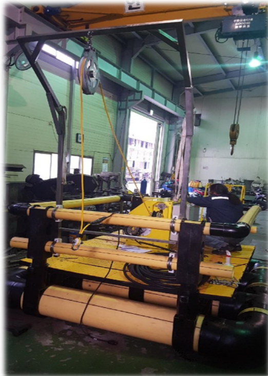
그림 3.1.30 양식장 해역 관측을 위한 수층 프로파일러 설치 부이
