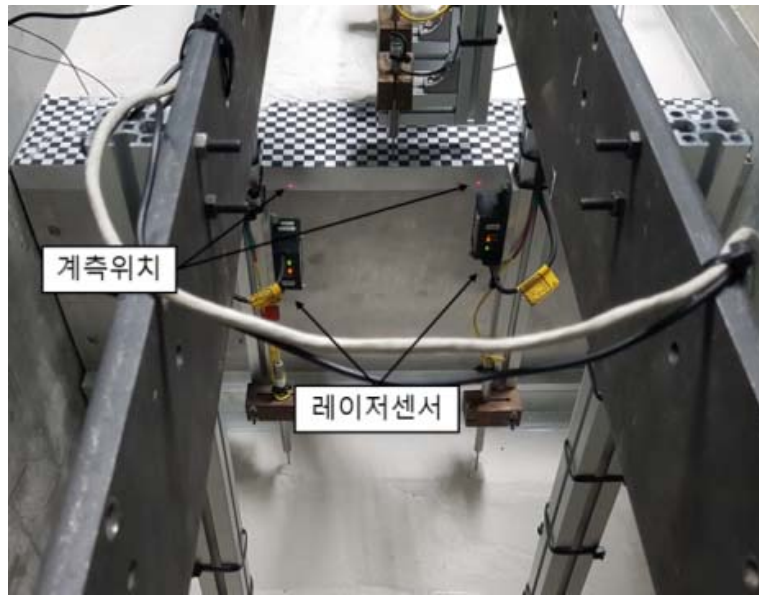
그림 3.4.34 레이저센서 설치 상세도
