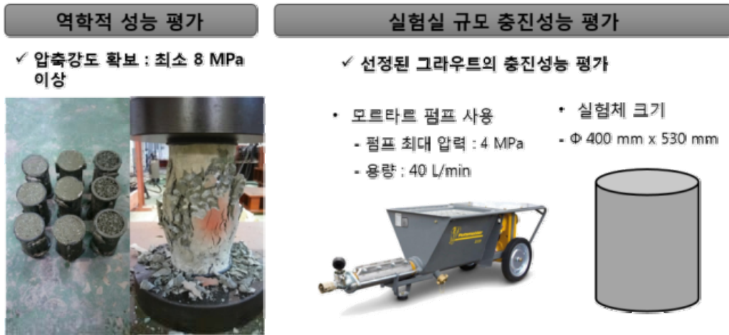
그림 3.2.2 지반보강 그라우트의 역학적 성능 및 충전성능 평가
