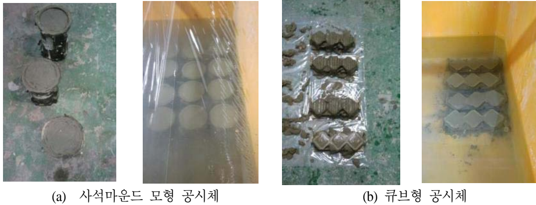
그림 3.2.36 공시체 제작 완료 및 수중양생
