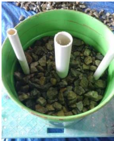
(a) 골재 투입 및 주입관과 배수관 설치
