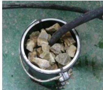
(a) 주입관 설치
