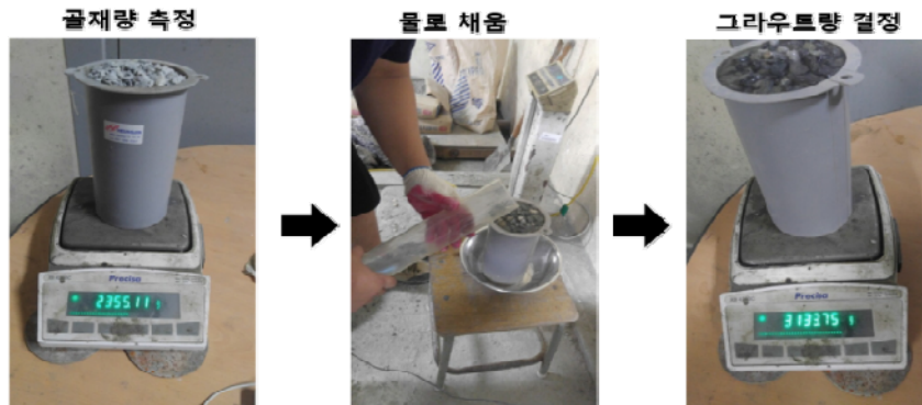
그림 3.2.34 골재 및 그라우트량 결정을 위한 예비 실험
