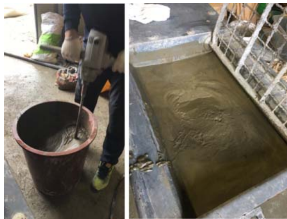
(a) 가소성 그라우트 믹싱 (b) 실험 전 호퍼에 투입된 그라우트 그림 3.2.74 충전성능 평가 실험을 위한 가소성 그라우트 준비 과정
