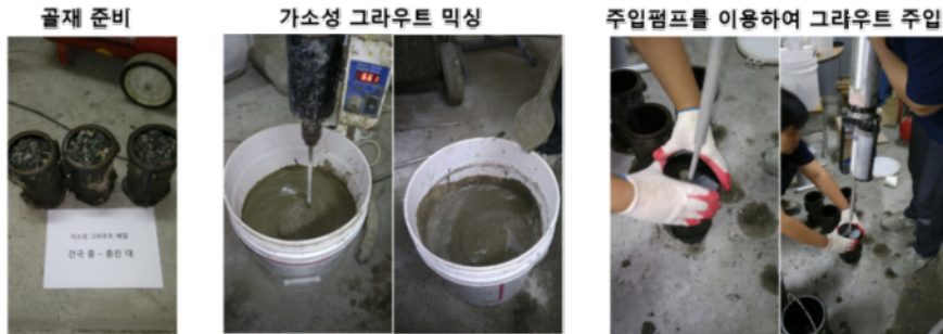
그림 3.2.25 가소성 그라우트 배합 공시체 제작 방법 - 간극 대, 간극 중
