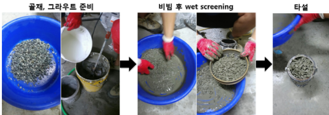
그림 3.2.22 시멘트 페이스트 + 수중불분리제 배합 공시체 제작 방법 - 충전정도 소
