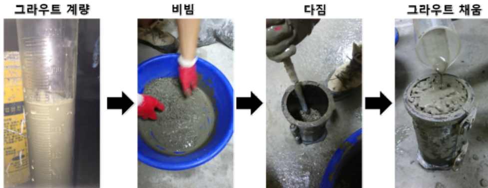
그림 3.2.23 시멘트 페이스트 + 수중불분리제 배합 공시체 제작 방법 - 충진정도 대
