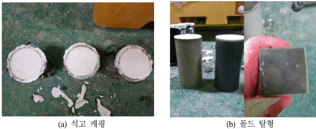
그림 3.2.37 사석마운드 모형 및 큐브형 공시체 탈형 모습
