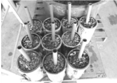
그림 3.2.11 그라우트재 속채움 실험을 위한 시험체 세팅
