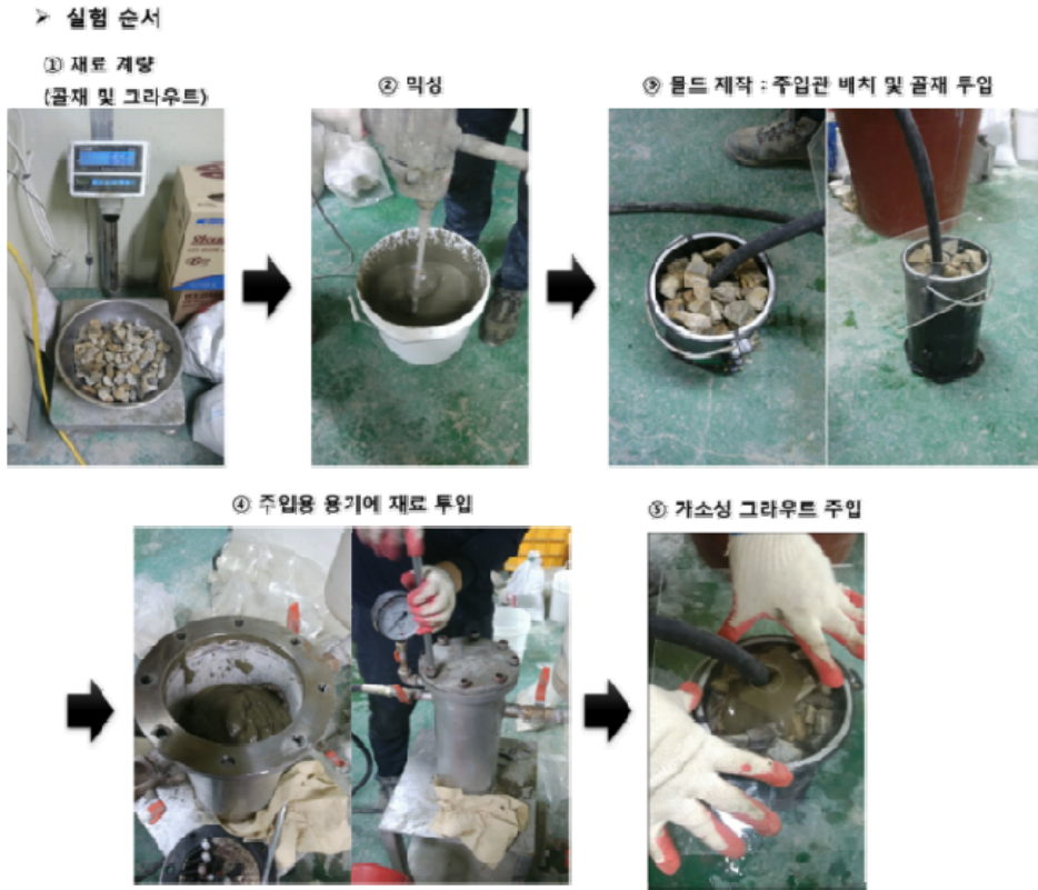
그림 3.2.63 가소성 그라우트 예비 주입실험 과정
