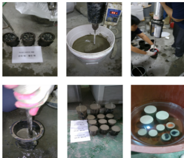
그림 3.2.27 가소성 그라우트 배합 공시체 제작 및 양생 과정
