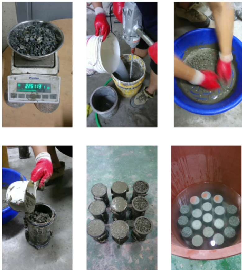
그림 3.2.24 시멘트 페이스트 + 수중불분리제 배합 공시체 제작 및 양생 과정
