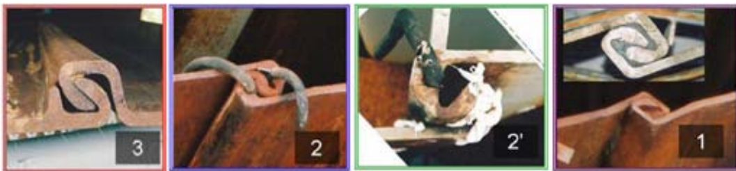
그림 2.2.11 강관널말뚝 접합부 충전재 연구(일본)
