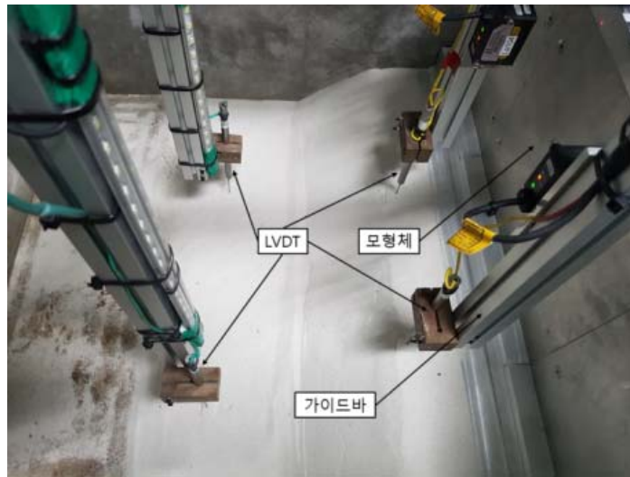
그림 3.4.24 LVDT 설치 상세도
