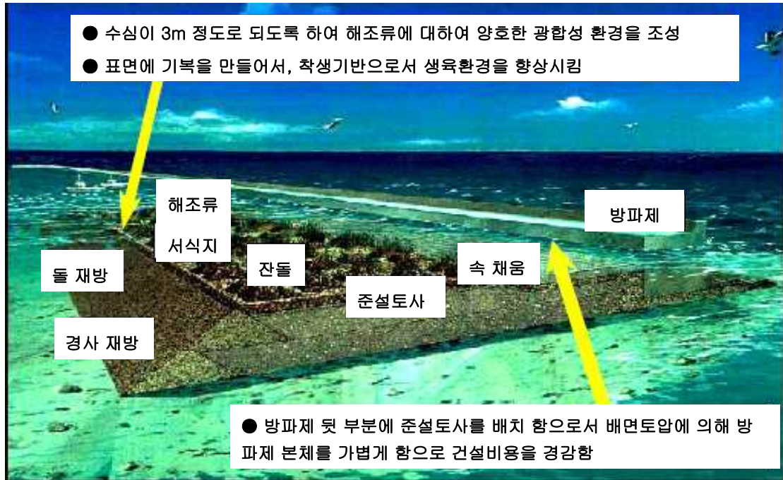
그림 2.3 케이싱 공법을 이용한 수저준설토 유효활용(일본 쿠시로 항, 방파제 조성)
