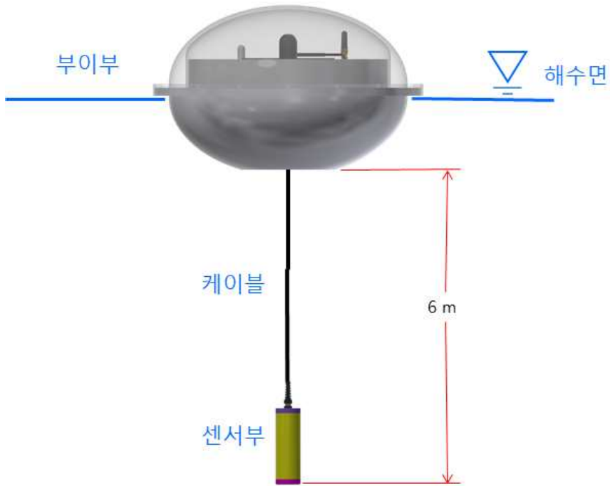
그림 3. ICT 소형 부이 시스템 구성도
