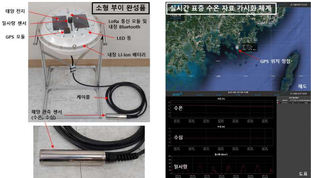
그림 16. ICT 소형 부이 설계 완성품 및 실시간 표층 수온 자료 가시화 체계 구축
