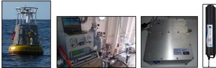
그림 72. 실시간 모니터링 장비 예 (좌측 2기:pCO<sub>2</sub>용, 우측 2기:pH용)
