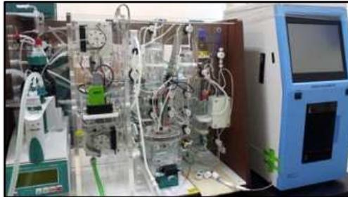
그림 71. 총 용존 무기탄소 및 총 알칼리도 측정 장비
