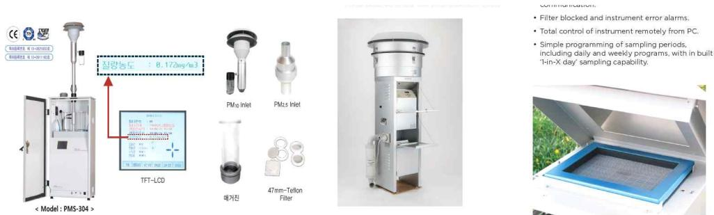
그림 73. 2019년 상반기 연구원에 도입 예정인 대기분진 모니터( 및 자동채취기) (왼쪽)와 자연/인공방사능 핵종 측정 시료 획득 위한 대용량 대기 분진 (분당  $\sim 1 \text{ m}^3$ ) 채취기 (오른쪽)
