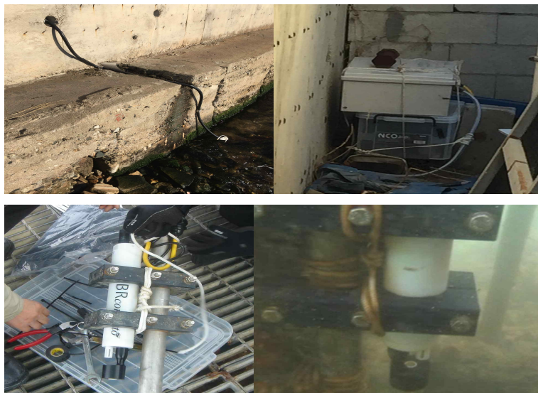
[그림 3-3] 동해연구소에 설치된 실시간 해양관측 시스템
