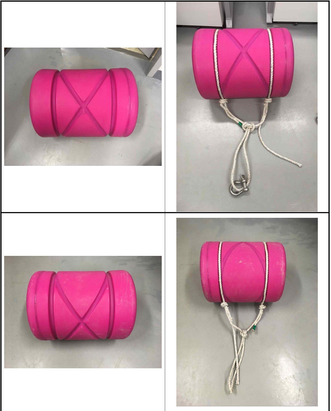
그림 13. 개발 부표 시제품의 해수내압성 시험 전(위)과 후(아래)의 모습.
