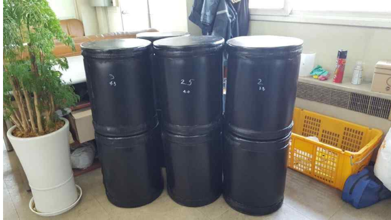
그림 7. 외부 막체의 적정 두께를 파악하기 위해 제작한 부표 모형.
