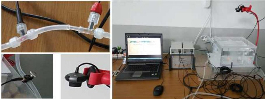
그림 17. 광학센서 및 호흡 센서 활용 실험 체계 구성
