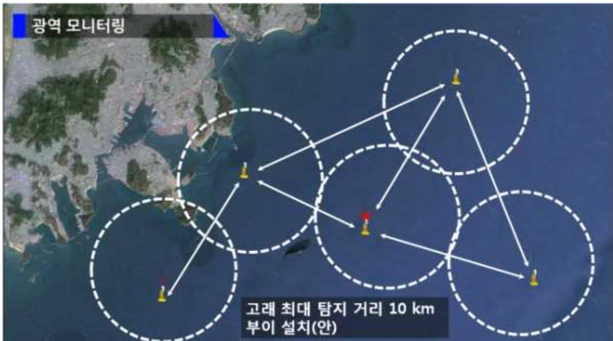
그림 45. 고래 모니터링 부이 설치(안)
