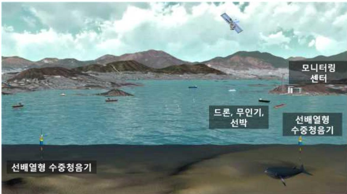
그림 40. 해양포유류 모니터링 시스템 개념도
