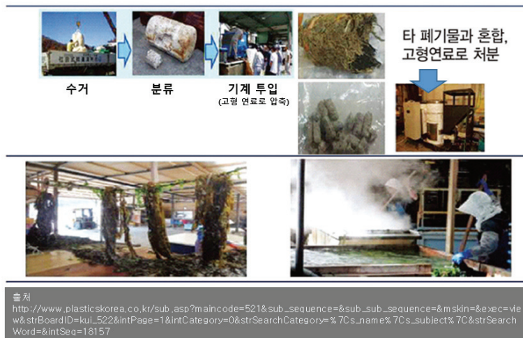
<그림 2-23> 일본의 페스티로폼 부표 처리 과정 및 자숙용 보일러 현장 사진
