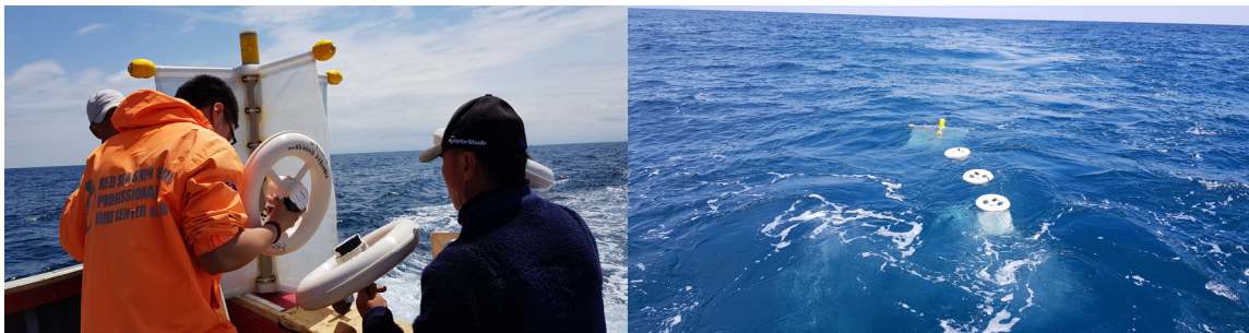
그림 3.2.6. K1 표류부이(수면 하 1미터관측)와 Carthe 부이(원반형태) 실험장면
