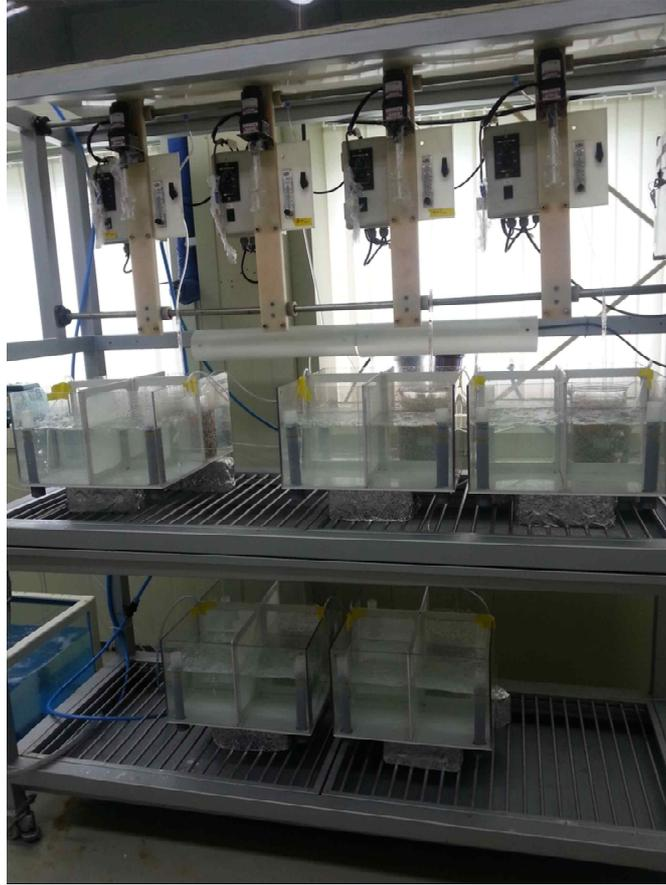
그림 1. 납치배아의 원유 노출을 위한 유수식 (continuous flow system) gravel effluent 노출장치
