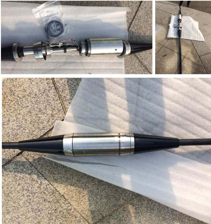
그림 40. 고강도 케이블 고도화가 적용된 센서
