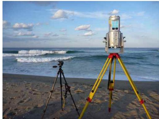
그림 27. LiDAR를 이용한 파고 관측
