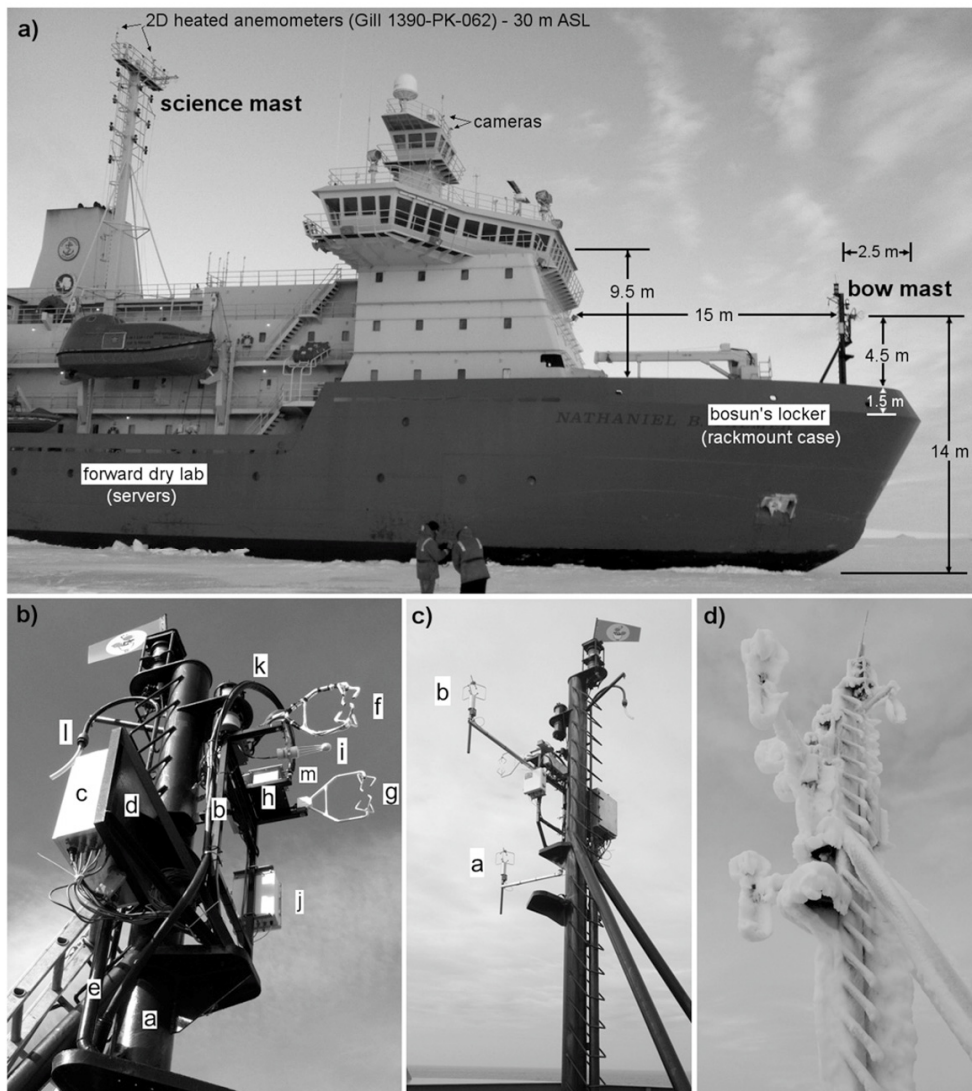
그림 2.12. R/V NBP에 설치된 자동 EC 플럭스 관측장비
