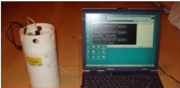
그림 3.21 수압식 파고계, WTG(장비 직경 : 0.12 m, 높이 : 0.23 m)
