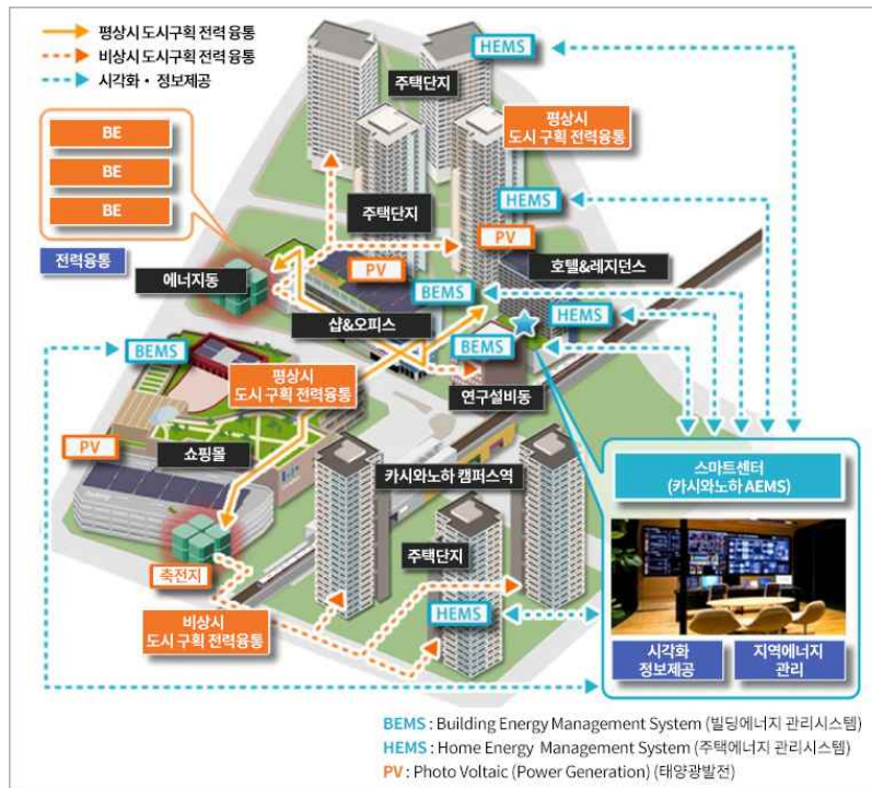
<그림 2-14> 카시와노하 스마트시티의 도시 전체를 효율적으로 운용, 감시, 제어하는 AEMS
