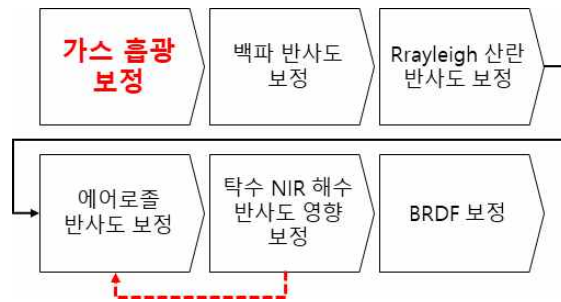
그림 128. 해색원격탐사를 위한 전체적인 대기보정 프로세스. AMI 산출자료 융합을 통해서 첫 단계인 가스흡광 보정 정확도를 크게 향상시킬 수 있음.
