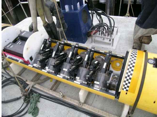
그림 1-1-2. MBARI의 AUV 및 채수시스템 Gulper
