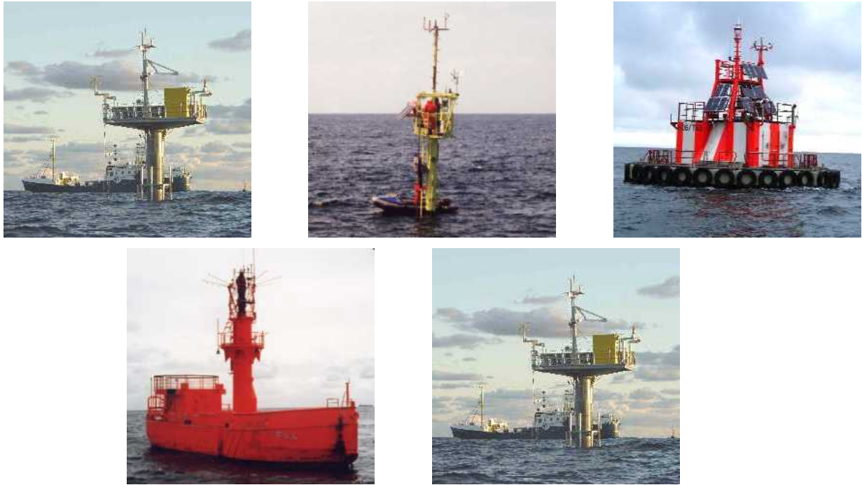
그림 2-1-7. 독일의 근해 해양환경 방사선/능 모니터링 설비
