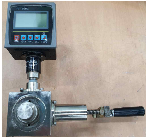
〈그림 3-4〉 구축된 Pull-off 부착강도시험기
