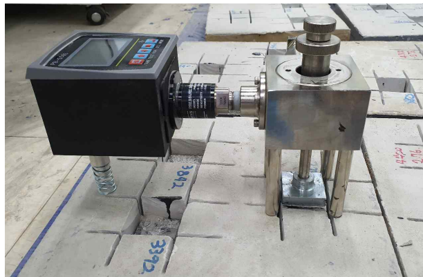
〈그림 3-7〉 Pull-off bond strength test setup
