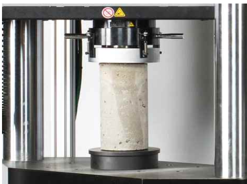
〈그림 1-6〉 유압식 만능시험 장비를 사용한 압축강도 시험
