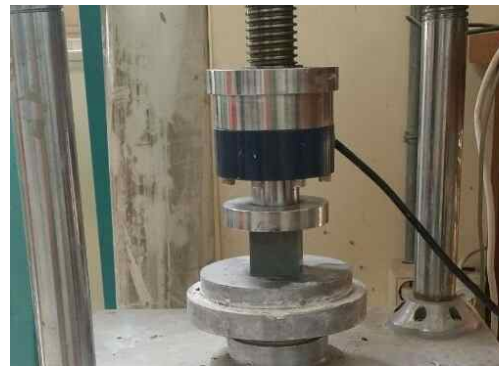
〈그림 1-6〉 유압식 만능시험 장비를 사용한 압축강도 시험
