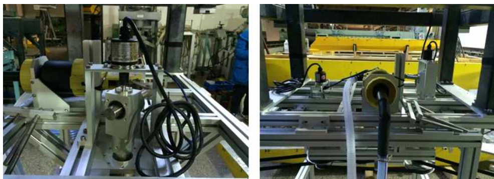
그림 214 단일 펌프의 동력전달계(좌)와 고정장치(우)
