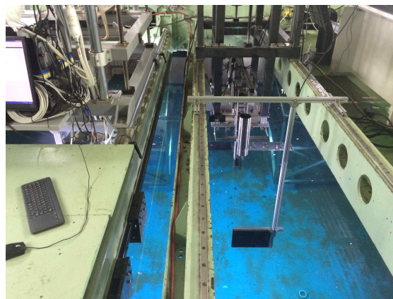
그림 225 레이저 각도의 비정렬을 보정 플레이트 설치 모습
